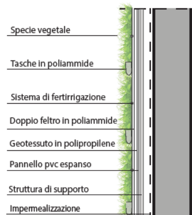
Dettaglio che mostra la stratigrafia di un muro vegetale.
